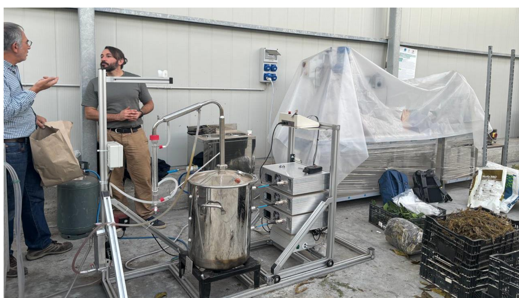
Prototipo di estrattore di distillatore in corrente di vapore assistito da microonde per l'estrazione di oli essenziali
