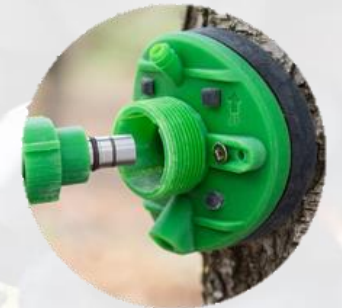
Sensore SATURAS nel tronco e collegato al tessuto vascolare
