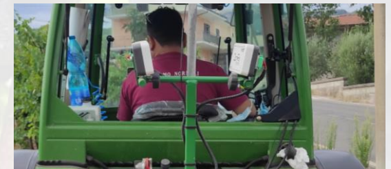
Sensori di vigore vegetativo OPTRX, misurano indici NDVI e NDRE (Fonte: Progetto VINTES)
