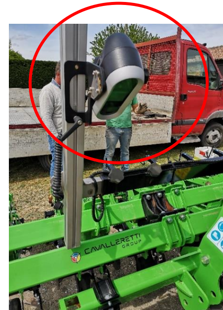
Lettore ottico che riconosce la fila coltivata
