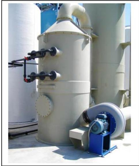
Veduta del modulo di estrazione dell'ammoniaca in corrente d'aria; in evidenza le 2 rampe di ugelli e il ventilatore
