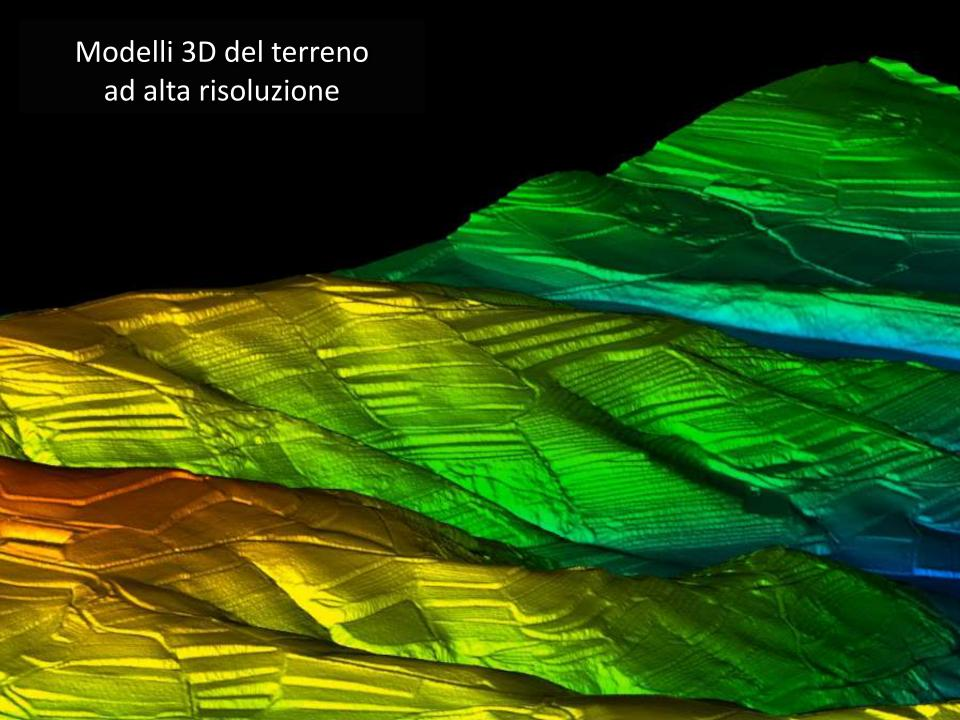
analisi di dettaglio del deflusso a scala aziendale (20 cm dimensione pixel, DTM)
