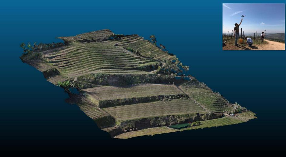
nuvola di punti 3D, rilievo fotogrammetrico con drone, con tecnica Structure from Motion (SfM)
