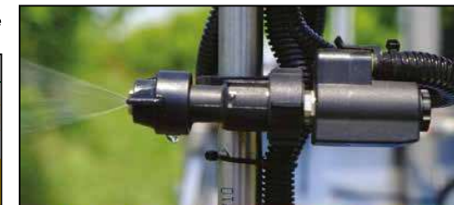
Figura 5. Particolare dell'ugello con tecnologia PWM montato sul robot operante nell'azienda Terre Grosse. È possibile notare lo stretto angolo di spruzzo (40°).
