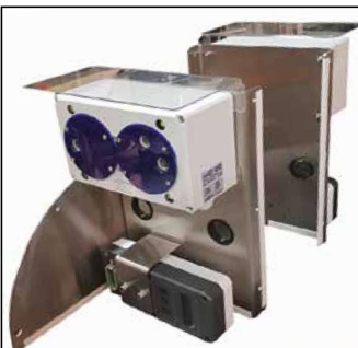
Figura 1. Stereo camere montate sulla testa del robot per il riconoscimento della vegetazione.
