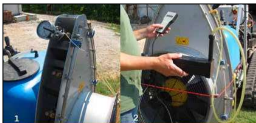
Figura 1. Rilievi sul gruppo irrorante: (1) misura pressione di esercizio; (2) verifica portata ugelli (luglio 2019).
