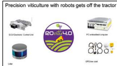
Figura 1. Componenti essenziali per navigazione autonoma in vigneto.
