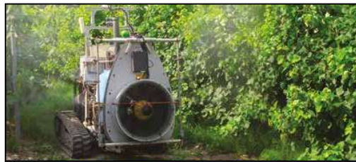
Figura 4. Il robot al lavoro nel 2020 presso l'azienda Pantano. Si nota la posizione degli ugelli, posti paralleli alla parete verticale.
