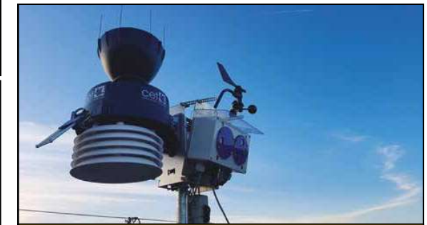
Figura 3: Stazione meteo dotata di sistema di visione, installata in vigneto per il funzionamento di modelli previsionali collegati alle attività del robot.
