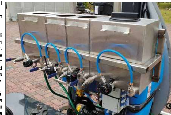
Figura 5. Particolare dei serbatoi per i fitosanitari.
