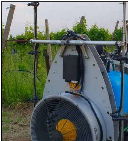
Figura 2. Particolare dell'atomizzatore a torretta, integrato con barre irroranti estensibili.
