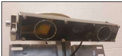
Figura 8. Stereo camera montata su testa del robot con sistema di protezione delle ottiche.
