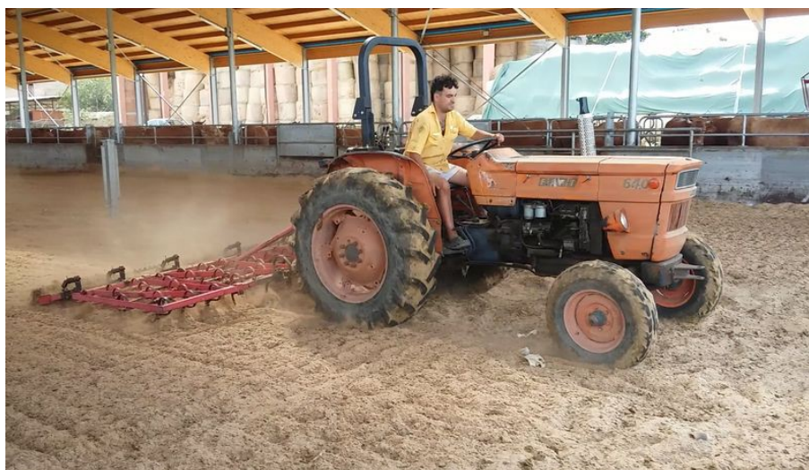
Figura 1.7 – Lavorazione della lettiera compost con erpice a denti portato da trattore
