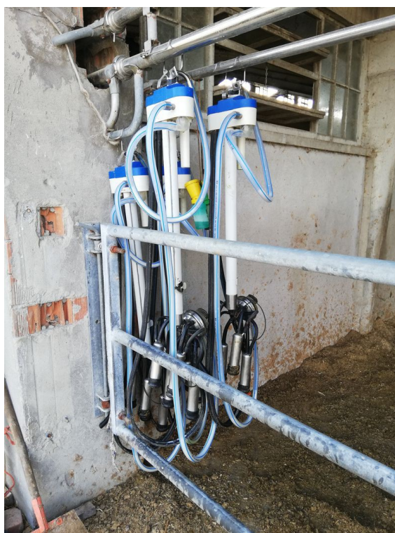
Figura 3.3 – I gruppi di mungitura mobili utilizzati per la mungitura alla rastrelliera nell'azienda A
